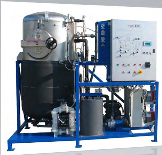
Processo com método de levar a solução à ebulição, a água evapora sendo condensada de imediato e recolhida na saída do aparelho como água destilada. O contaminante, fração menos volátil, permanece no evaporador estando concentrado ao máximo, e pronto para ser descarregado ciclicamente.
